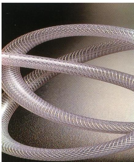
**ARIANNA - TA** cev je izdelana iz dvoslojne brizganega PVC –ja. Vmesni sloj tvori rayon pletenica, ki daje cevi kompaktnost, odpornost na delovni tlak in delno na podtlak. Namenjena je za domačo in industrijsko uporabo na pretočnih in avtomatiziranih strojih, za pretok zraka, vode, blagih kemikalij, hrane ipd. V našem programu je vedno izdelana iz **netoksičnega PVC – ja**. Na hrano odporna po normah Ia, Iv, Iva, IVb, D.M. 4.4.1985
